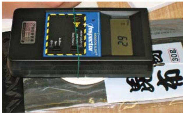
図2：インスペクターによる昆布の放射線量の測定
